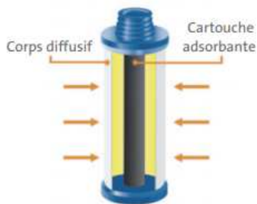
Figure 4 : Schéma de principe d'un tube Radiello
