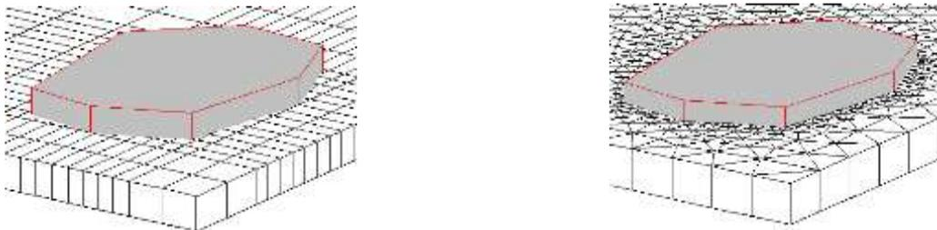
*Figure 27 : Exemple de maillages structuré et non-structuré.*
