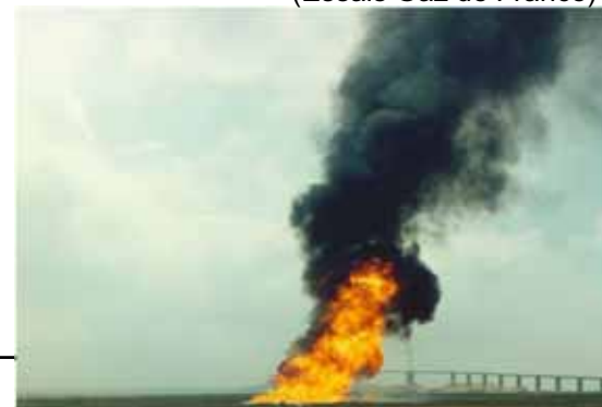
Feu de nappe de GNL sur l'eau (Essais Gaz de France)
