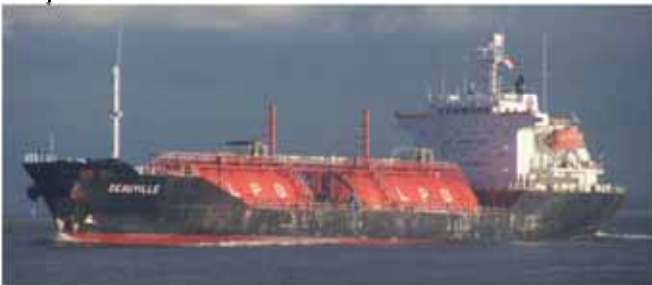
Navire transporteur de gaz équipé de citernes pressurisées
