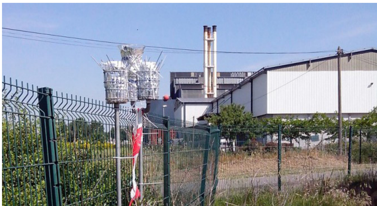
Figure 39 : Mesures des flux de dépôts atmosphériques par jauges de sédimentation.
