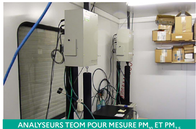
Figure 34 : Exemples d'analyseurs fixes ou embarqués dans un moyen mobile.
