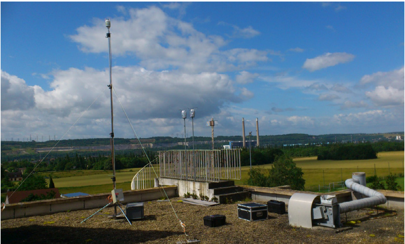
Figure 48 : Station météorologique mise en place pendant une campagne de mesure sur un mât de 10 m.
