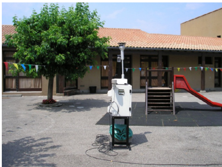
Figure 35 : Préleveur sur filtres de particules en suspension permettant la détermination des concentrations massiques en PM 10 et ETM associés.
